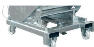
EXPO 150-275: 2 roulettes pivotantes (dont 1 avec arrêteur) et 2 roulettes fixes en polyamide Ø 100 mm – hauteur de construction 125 mm
