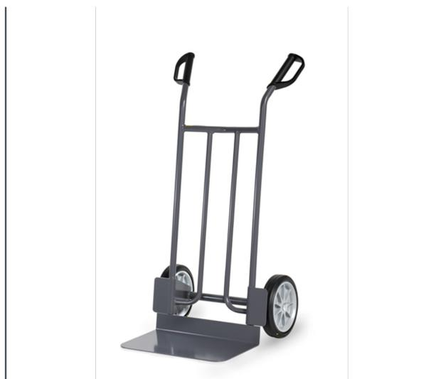
Tous les éléments sont conducteurs d'électricité. Ensemble mécano-soudé en tube et tôle d'acier, revêtement époxy gris foncé RAL 7015. ESD-poignées de sécurité en plastique dur avec arceaux de sécurité. Bavette en tôle d'acier vissé et remplaçable. Roues à bandage ESD-caoutchouc, moyeu à roulement à rouleaux.
