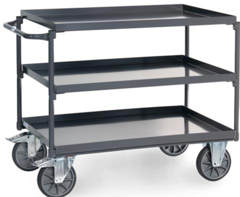
Tous les éléments sont conducteurs d'électricité. Construction en acier avec 3 plateaux étanches et rebord de 40 mm, revêtement époxy gris ardoise RAL 7015, dossier de poussée horizontal. Charge maximum plateaux du haut : 200 kg. 2 roues pivotantes et 2 roues fixes à bandage TPE-ESD (Élastomère thermoplastique), conductrices d'électricité, moyeu à roulement à billes central. Freins sur roues pivotantes conformément à la Norme 1757-3 (Sécurité des chariots de manutention).
