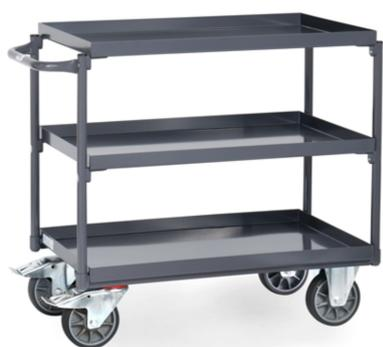
Tous les éléments sont conducteurs d'électricité. Construction en acier avec 3 plateaux étanches et rebord de 40 mm, revêtement époxy gris ardoise RAL 7015, dossier de poussée horizontal. Charge maximum plateaux du haut : 200 kg. 2 roues pivotantes et 2 roues fixes à bandage TPE-ESD (Élastomère thermoplastique), conductrices d'électricité, moyeu à roulement à billes central. Freins sur roues pivotantes conformément à la Norme 1757-3 (Sécurité des chariots de manutention).
