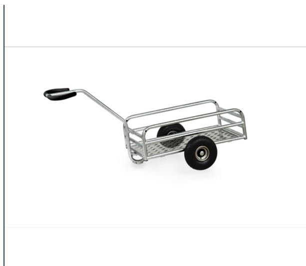
Chars à bras léger pour une utilisation en extérieur, en tube d'acier soudé, galvanisé, plateforme en tôle alu larmé, tubulure renforcée hauteur 180/250 mm. Timon sécurisé boulonné avec revêtement souple. Grandes roues avec jante en acier zingué, mousse polyuréthane increvables, moyeu à roulement à rouleaux, fixation des roues par vis pour faciliter le remplacement.
