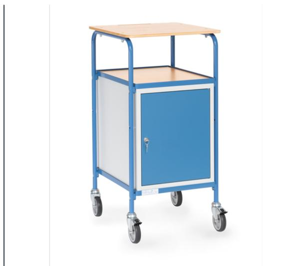
Ensemble mécano-soudé et boulonné, revêtement époxy bleu RAL 5007, dimensions écritoire (l x P) : 605 x 589 mm, avec porte-stylo fraisé. 1 placard verrouillable en tôle d'acier (L X P X H : 500 x 600 x 600 mm) avec porte et 2 étagères amovibles. 4 roues pivotantes dont 2 avec freins, moyeu à palier lisse. Charge maximum par plateau : 30 kg.
