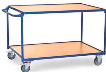
Ensemble mécano-soudé, revêtement époxy bleu RAL 5007 avec 2 plateaux en mélaminé surface effet hêtre, barre de poussée horizontale, rebord de 12 mm. Charge maximum de l'étagère haute et médiane : 80 kg. 2 roues pivotantes et 2 roues fixes à bandage TPE, moyeu à roulement à billes central. Freins sur roues pivotantes, conformément à la Norme EN 1757-3.
