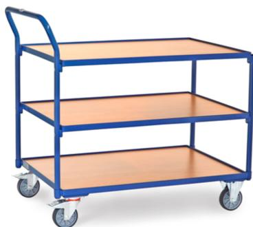
Ensemble mécano-soudé, revêtement époxy bleu RAL 5007 avec 3 plateaux en mélaminé surface effet hêtre, barre de poussée verticale, rebord de 12 mm. Charge maximum étagère haute et médiane : 80 kg. 2 roues pivotantes et 2 roues fixes à bandage TPE, moyeu à roulement à billes central. Freins sur roues pivotantes, conformément à la Norme EN 1757-3.
