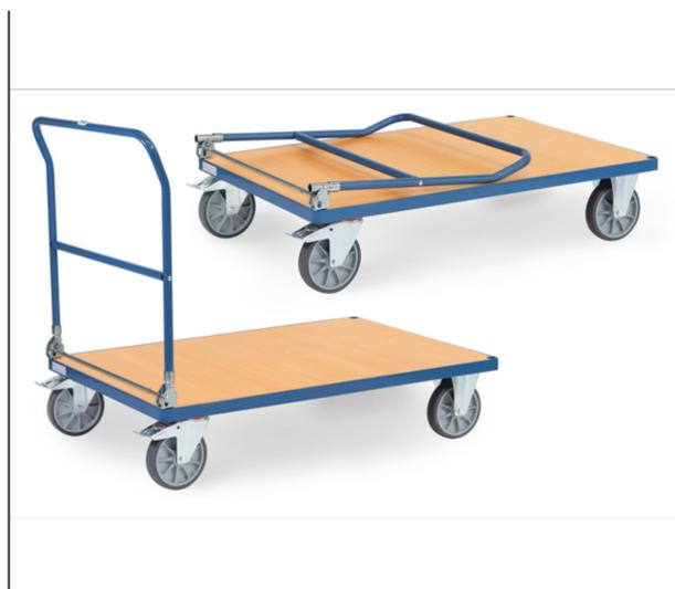
Chariot en d'acier mécano-soudé, revêtement époxy avec plateforme en mélaminé surface effet hêtre. Dossier de poussée rabattable sur la plateforme. 2 roues pivotantes et 2 roues fixes à bandage TPE, moyeu à roulement à billes central. Freins sur roues pivotantes.
