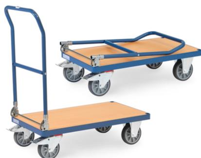
Chariot en d'acier mécano-soudé, revêtement époxy avec plateforme en mélaminé surface effet hêtre. Dossier de poussée rabattable sur la plateforme. 2 roues pivotantes et 2 roues fixes à bandage TPE, moyeu à roulement à billes central. Freins sur roues pivotantes.
