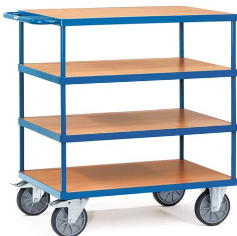
Ensemble mécano-soudé, revêtement époxy bleu RAL 5007 avec 4 plateaux en mélaminé surface effet hêtre. Charge maximum plateau du haut : 200 kg. 2 roues pivotantes et 2 roues fixes à bandage TPE, moyeu à roulement à billes central. Freins sur roues pivotantes, conformément à la Norme 1757-3 (Sécurité des chariots de manutention).
