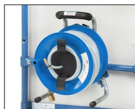
**Enrouleur de tuyau à air comprimé**
